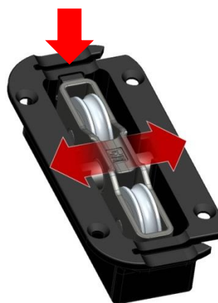
Figur 2 - Hjulene låses ved at trykke hjulet, ved den lille pal, op i hjulhuset
